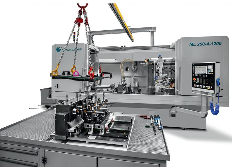
1 Ein von TBT und dem Anwender konzipiertes Werkzeugwechselsystem ermöglicht das hauptzeitparallele Rüsten kompletter Werkzeugeinheiten außerhalb der Tiefbohrmaschine des Typs ML250-4-1200. So spart der Anwender zusätzliche Rüst-Nebenzeiten ein © TBT
