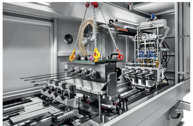
2 Auf das Maschinenbett abgesetzte komplette Werkzeugeinheit. Durch den transparenten Schlauch in der Bildmitte wird der Ölnebel, der beim Ausblasen der Bohrungen entsteht, abgeführt © TBT
