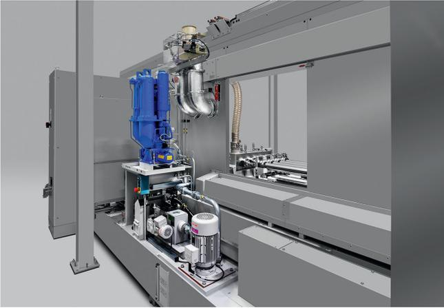
3 Auf der Rückseite der Maschine ist genügend Platz für den Beladeroboter. Sein Arm reicht die Werkstücke durch eine automatische Luke hindurch © TBT
